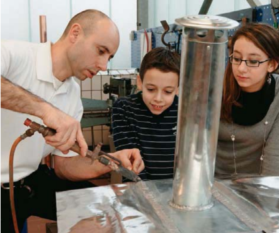
So geht das: Vater Fabio Fratello erklärt Tochter Laura und Sohn Alessio seine Arbeit. Der Klempner muss natürlich löten können (oben) und Quetschfalten ausbilden (rechts).
